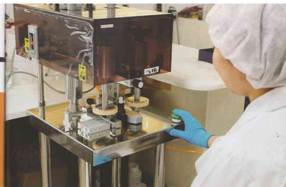
キャップ締め工程を自動化
